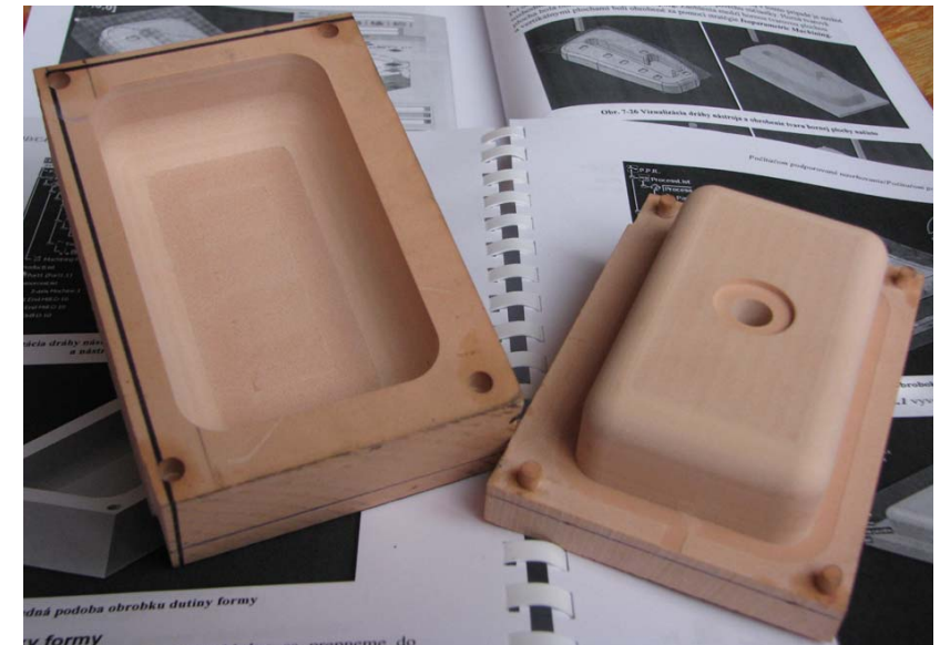
Obr. 5-126 Model formy ze syntetického dřeva
