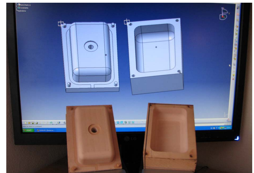
Obr. 5-127 Porovnání virtuálního modelu s reálně obroběným modelem
